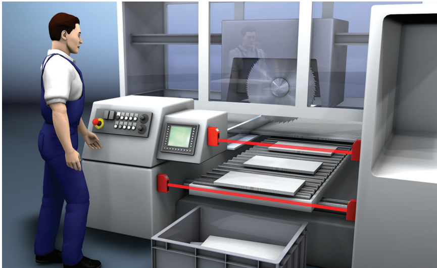
Sécurisation d'une machine à bois à l'aide de barrages immatériels monofaisceau de sécurité SLSR 46B et d'un appareil de surveillance de sécurité MSI-T
