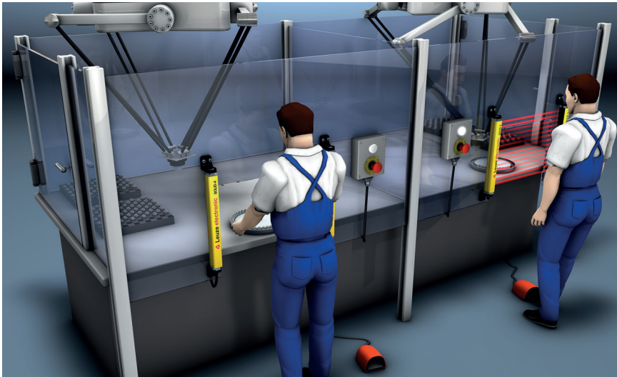
Les contrôleurs programmables de sécurité tels que le module de base autonome MSI 100 commandent la sécurité au sein des processus de fabrication automatisés.
